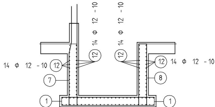
13 Verfahren Sie nun mit der horizontalen Bewehrung der Querseite analog wie zuvor beschrieben. Aktivieren Sie zur Eingabe der Biegeform in den Eingabeoptionen die **Expansion an Schalkanten**, legen Sie im Schnitt B-B eine neue Verlegetherade im Bereich der Schachtwand von oben nach unten fest und schalten Sie abschließend wiederum im Grundriss der Bodenplatte die Querbewehrung unsichtbar.
