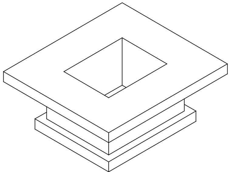
Sie zeichnen eine Aufzugsunterfahrt für das Kellergeschoss der Übung 1 mit Funktionen des Aufgabenbereichs **3D-Objekte** bzw. alternativ mit Funktionen des Aufgabenbereichs **Bauteile**.
