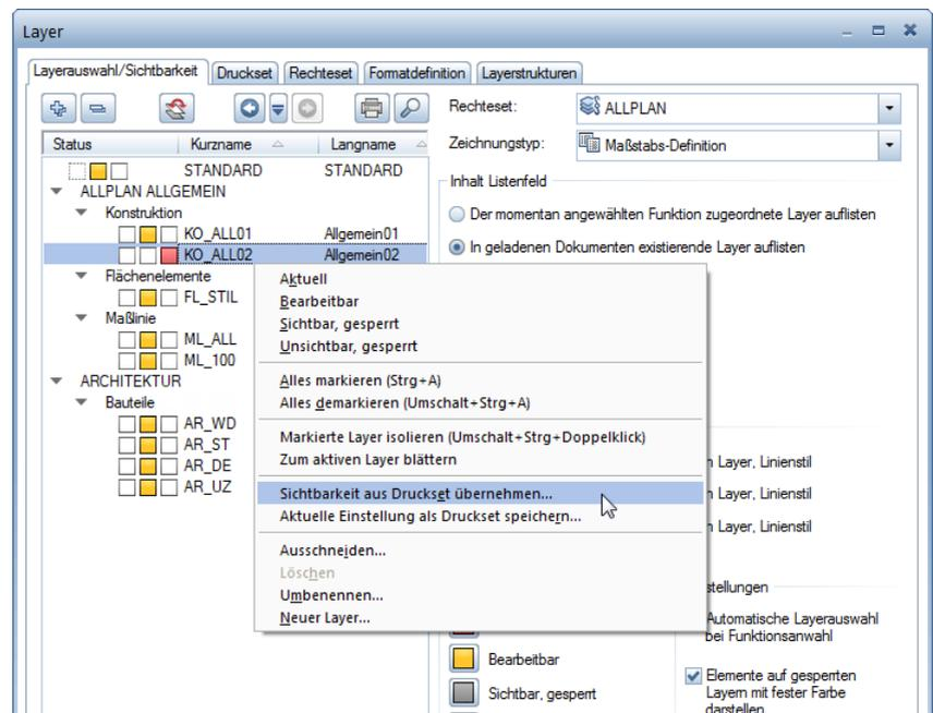
**Tipp:** Beim Druckset **Schalplan** ist die Konstruktion doppelt vorhanden. Die Darstellung nur eines Grundrisses können Sie entweder über die Sichtbarkeit der Layer oder die Teilbildanwahl beeinflussen.
