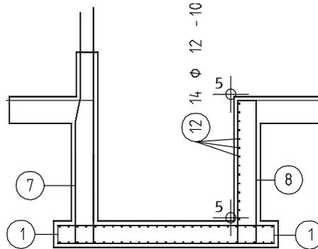
12 Sie können jetzt Position 12 entlang der weiteren vertikalen Eisen verlegen oder die Verlegung gespiegelt kopieren:
