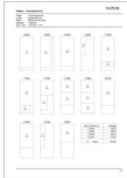
Zunächst erzeugen Sie die Schneideskizze für die untere Mattenlage.
