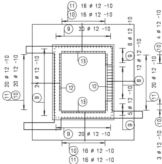
Die Aufzugsunterfahrt ist jetzt, mit Ausnahme der horizontalen Eckverbügelung, die als Regeldetail dargestellt wird, fertig bewehrt. Zum Abschluss legen Sie den endgültigen Schnittbereich der Schachtwände fest.
