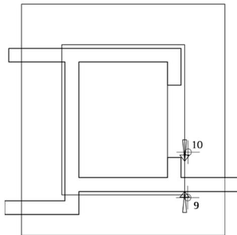
Der Verlegebereich wird im Grundriss der Schachtwände markiert, die Verlegung wird im Grundriss der Bodenplatte angezeigt. Unabhängig von der gewählten Verlegedarstellung, werden alle Eisen dargestellt, da die Wandanschlüsse nicht im Schnittbereich der Schachtwände liegen.
