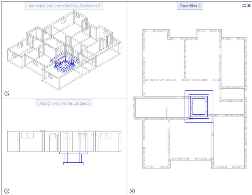
Aus dieser Unterfahrt sowie dem Kellergrundriss werden Sie später in Übung 4 mit Funktionen des Aufgabenbereichs **Schnitte** Schnitte erzeugen und mit Funktionen des Aufgabenbereichs **Rundstahl** bewehren.
