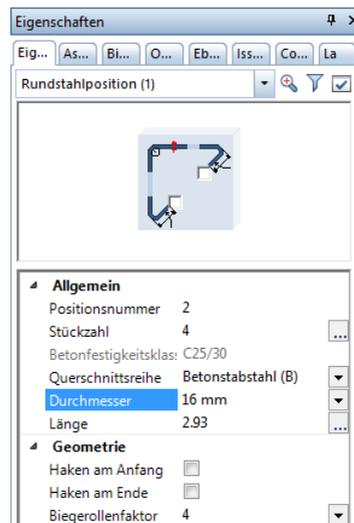
**Hinweis:** Wenn Sie den Durchmesser der unteren Längsbewehrung ebenfalls mit der Direkten Objektmodifikation ändern möchten, aktivieren Sie die gesamte Verlegung im Schnitt als Segment mit Umschalt+Klick.
