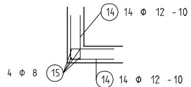
Durch die Verwendung von PythonParts werden der erzeugten Bewehrung Verlegestückzahlen zugeordnet, ohne dass Sie die Eisen über einen bestimmten Bereich verlegen müssen. Die Bewehrung kann so nur in einer Ansicht dargestellt werden.
