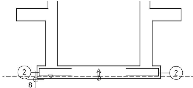
Die gestrichelte Linie zeigt die aktuelle Lagertiefe der Bewehrung unter Berücksichtigung der Betondeckung. Das Höhenkoten-symbol gibt die Lagertiefe des eingegebenen Definitionspunktes wieder. Der Pfeil zeigt die Richtung der positiven Eisenschenkel und die Verlegerichtung des Stabes.
