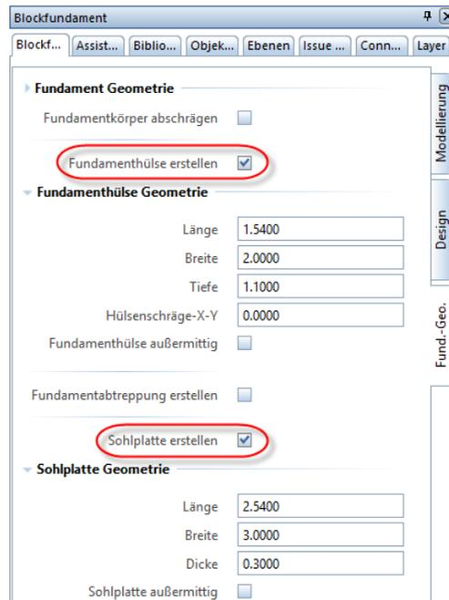
Das modellierte Bauteil hängt als Vorschau am Fadenkreuz. Als Absetzpunkt wird die linke untere Wandecke des Aufzugs-schachtes verwendet. Bezugspunkt des Bauteils ist der obere Mittelpunkt des Blockfundaments.
