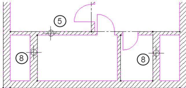
Die Wände werden nun mit der neuen Dicke gezeichnet. Ggf. müssen Sie die Wände nun wieder an die anderen Innenwände anschließen.
