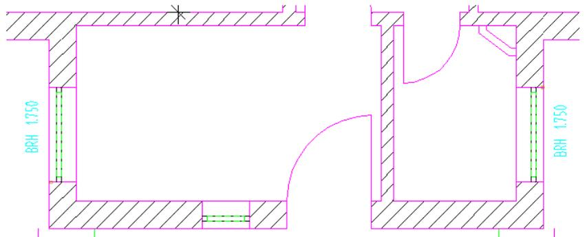
7 Beschriften Sie alle weiteren Brüstungshöhen, indem Sie den Öffnungspunkt anklicken und die Beschriftung absetzen. Beachten Sie die Textrichtung.
