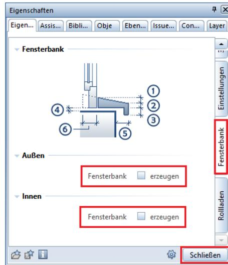
Das SmartPart wurde mit den veränderten Parametern in die Öffnung eingefügt.
