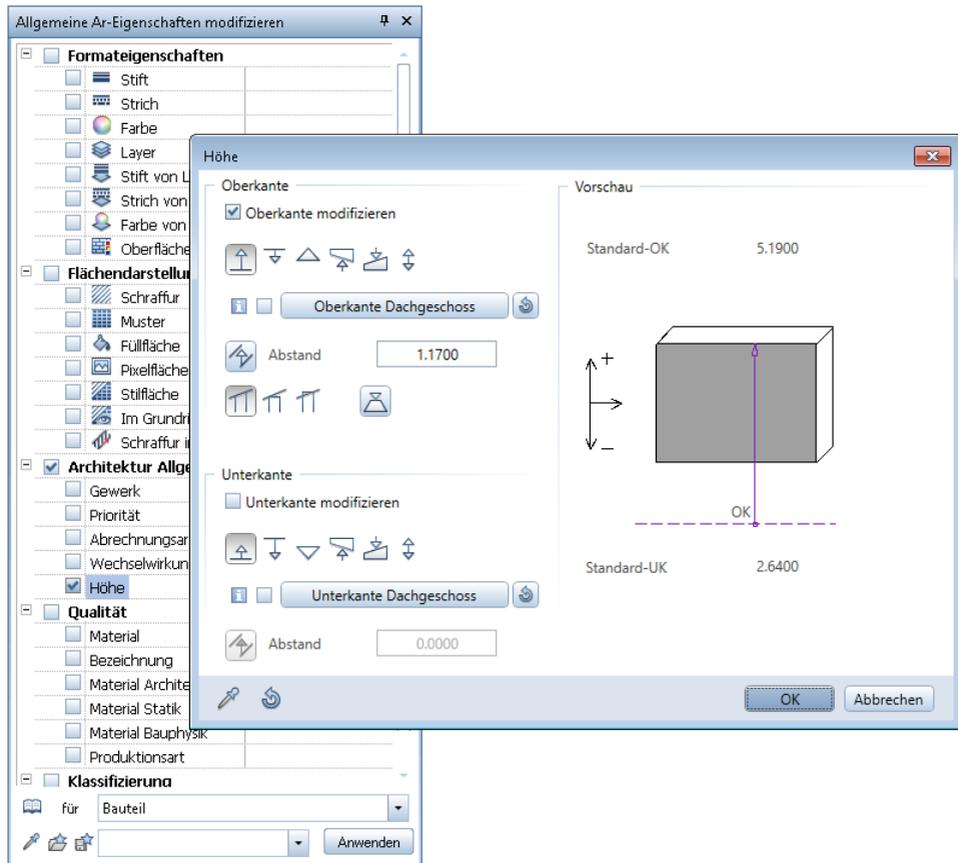
**Tipp:** Wenn die Wände nicht vollständig die neue Höhe annehmen, muss der Wandanschluss der angrenzenden Außenwände mit **Linienbauteil an Linienbauteil** geändert werden.
