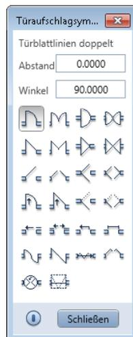
**Tipp:** Türaufschläge können sehr einfach geändert werden: Aktivieren Sie die Funktion **Tür** und klicken Sie in die Türöffnung. Wählen Sie im Dialogfeld **Türaufschlag** einen neuen Aufschlag aus. Der alte wird automatisch gelöscht.
