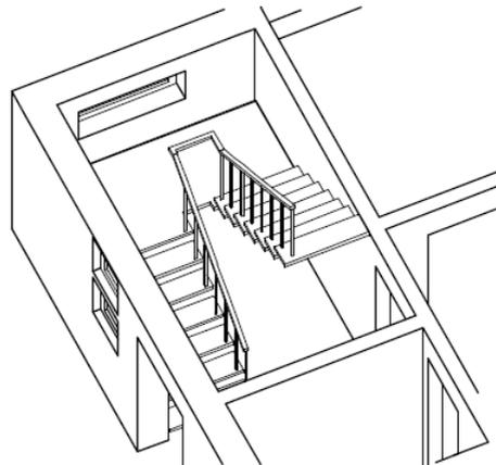
Bevor Sie mit der eigentlichen Treppenkonstruktion beginnen, bereiten Sie den Treppenumriss als Hilfskonstruktion vor. Die Treppeneingabe wird dadurch einfacher.
