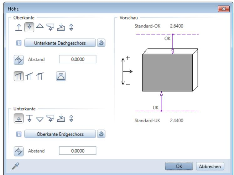
Die Erdgeschoss-Decke liegt mit ihrer Unterkante an der **Oberkante Erdgeschoss** (2,44m) und mit ihrer Oberkante an der **Unter­kante Dachgeschoss** (2,64m). Die Deckenstärke beträgt 20 cm, so dass die Decke ohne Abstand an die obere und die untere Standardebene gebunden werden kann.
