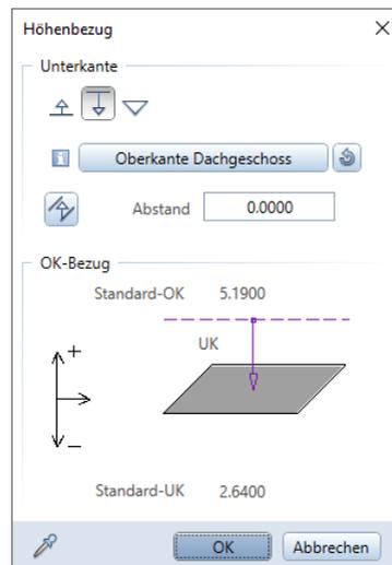
Über die Schaltfläche rechts neben dem
