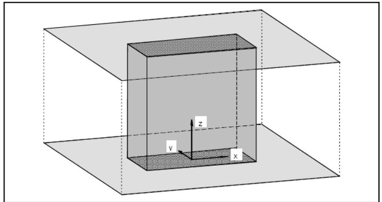
Die Höhenlage der Standardebenen ist für jedes Teilbild einzeln einstellbar. Wenn Ober- und Unterkanten der Bauteile eines Geschosses an die Standardebenen „gebunden“ sind, wird mit einer Änderung der Standardebenen das gesamte Geschoss gestreckt oder gestaucht. So lässt sich mit einer Änderung die Geschosshöhe für alle Bauteile ändern.
