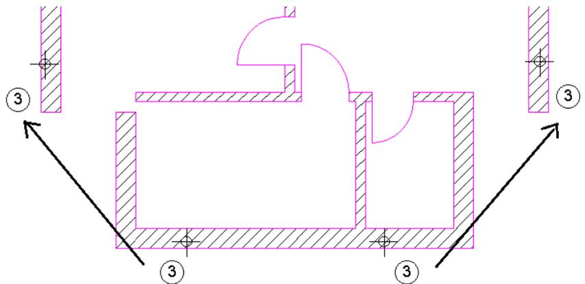
4 Schließen Sie nun die unteren Innenwände an die Außenwände an. Auch die ehemalige Außenwand unten links muss noch an die eben verlängerte Innenwand angeschlossen werden.
