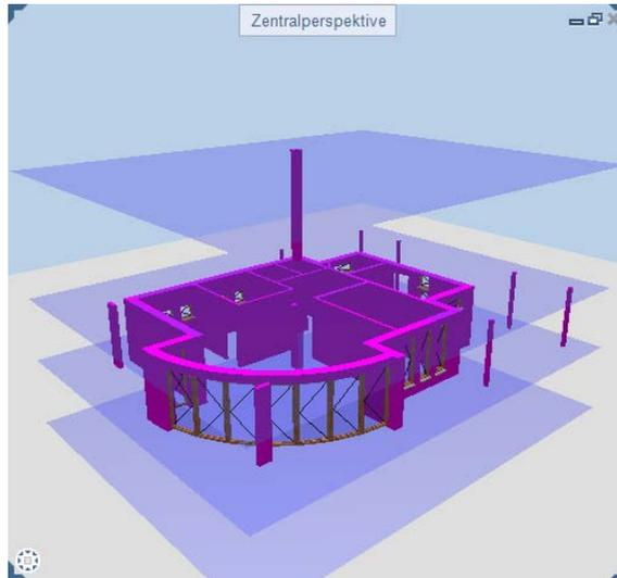
In der Animation werden alle bisher für die Konstruktion verwendeten Standardebenen dargestellt. Man erkennt, an welche Ebenen die einzelnen Bauteile angebunden sind.
