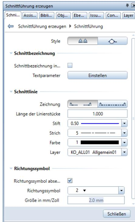
**Tipp:** Außer orthogonalen Schnitten sind auch Schnitte mit einem beliebigen Winkel und versetzten Schnittlinien möglich.
