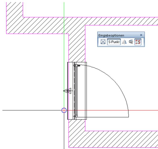
**Hinweise:** Wurde die Öffnung (wie in unserem Fall) mit Leibung erzeugt, dann wird das SmartPart immer in der Mitte der Fensterleibung abgesetzt. Dabei ist es egal, an welcher Stelle die Öffnung angeklickt wird. Ist keine Leibung in der Öffnung vorhanden, springt das SmartPart mittig in die angeklickte Wandschicht.
