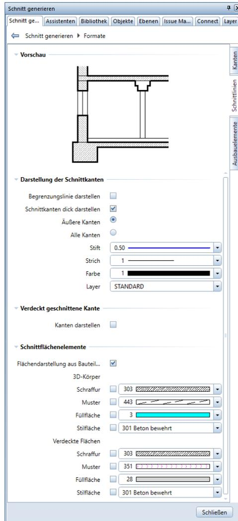
**Tipp:** Wenn Sie z.B. mit **Raum** Ausbauflächen definieren, können diese im Schnitt dargestellt werden (Unterpalette **Formate**, Registerkarte **Ausbauelemente**). So können Sie sich ggf. einen Teil der Nachbearbeitung der Schnitte sparen.
