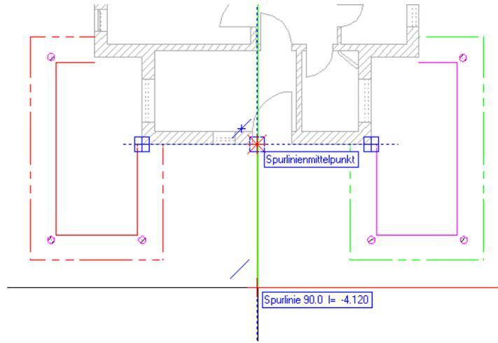
Die Spiegelachse soll parallel zur y-Achse verlaufen.
