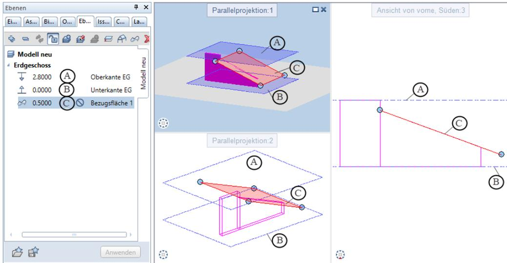
Im oben gezeigten Beispiel wurde eine Wand zum Teil an die schräge **Bezugsfläche (C)** und zum anderen Teil an die Standardebene **Oberkante EG (A)** gebunden.
