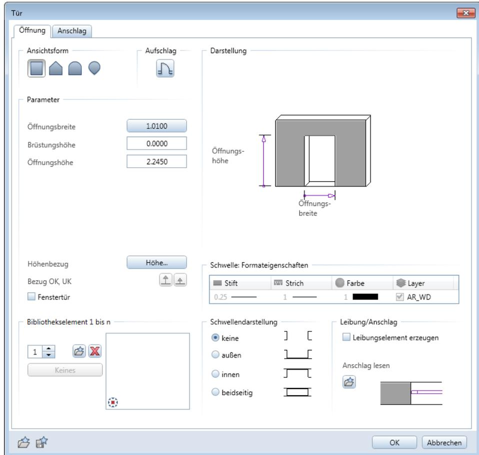
**Tipp:** Die Öffnungsbreite im Dialogfeld ist ein Vorschlagswert und kann korrigiert werden. So können Sie schnell mehrere Türen gleichen Typs und gleicher Höhe mit unterschiedlicher Breite zeichnen.
