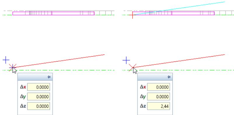
Die erste 3D-Fläche ist an der richtigen Position erstellt. Die zweite 3D-Fläche erzeugen Sie durch Kopieren und Spiegeln.
