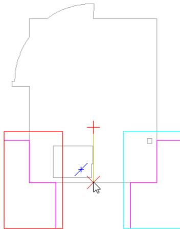
Um die 3D-Flächen als Bezugsflächen nutzen zu können, verwenden Sie die Funktion **3D-Fläche in Bezugsfläche** (Kontextmenü von 3D-Flächen). Damit werden lokale Bezugsflächen erstellt, das heißt diese Bezugsflächen stehen im momentan aktiven Teilbild zur Nutzung zur Verfügung. Um die 3D-Flächen in allen Teilbildern Ihres Projektes als Bezugsflächen zu haben, gibt es die Möglichkeit, die 3D-Flächen als Bezugsflächen in Ihr Ebenenmodell einzubinden.
