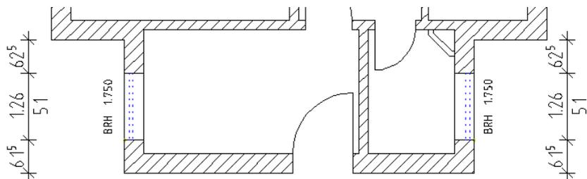
16 Setzen Sie den nächsten Punkt für eine Fensteröffnung in der **rechten Außenwand** ab, klicken Sie in den  **Eigenschaften** auf **Höhe** und verändern die Höhenparameter von **Oberkante** und **Unterkante** (Brüstungshöhe):
