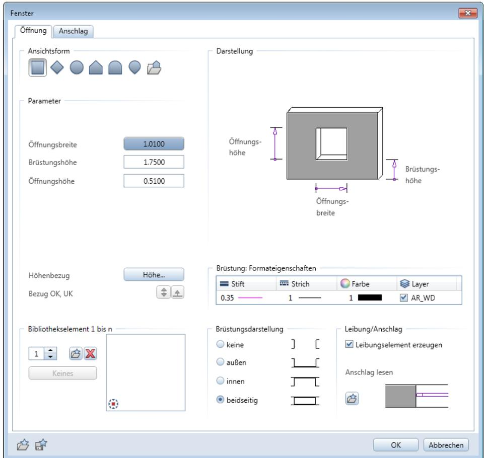
**Tipp:** Im Dialogfeld **Fenster** wird der Wert **Brüstungshöhe** angezeigt. Dieser zeigt die relative Höhe der Brüstung zur Ebene oder zu einem Bezugsbauteil an.
