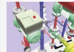
Mit dem Modul Heizung erstellen Sie auch sehr komplexe Anlagen ohne großen Aufwand. Die Basis für die Planung bilden Rohrnetzberechnungen, die AX3000 anhand der definierten Parameter automatisch durchführt.
