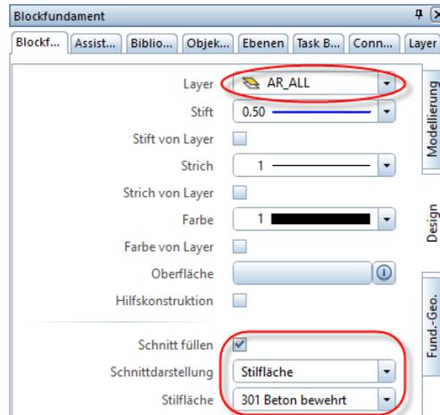
6. Wählen Sie die Registerkarte **Fund.-Geo.** und legen Sie die Höhenlage und die Abmessungen des Fundaments fest:
