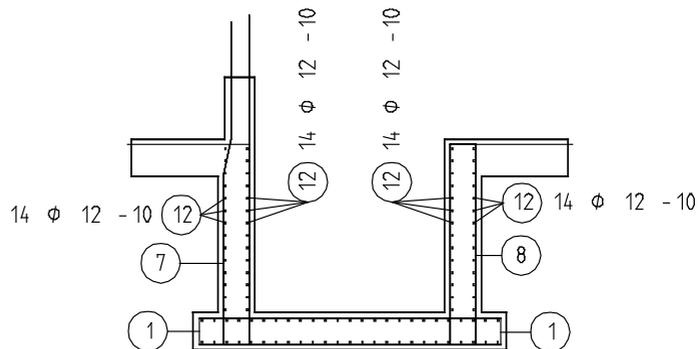
13 Verfahren Sie nun mit der horizontalen Bewehrung der Querseite analog wie zuvor beschrieben. Aktivieren Sie zur Eingabe der Biegeform in den Eingabeoptionen die **Expansion an Schalkanten**, legen Sie im Schnitt B-B eine neue Verlegeterade im Bereich der Schachtwand von oben nach unten fest und schalten Sie abschließend wiederum im Grundriss der Bodenplatte die Querbewehrung unsichtbar.
