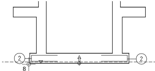
Die gestrichelte Linie zeigt die aktuelle Lagertiefe der Bewehrung unter Berücksichtigung der Betondeckung. Das Höhenkotensymbol gibt die Lagertiefe des eingegebenen Definitionspunktes wieder. Der Pfeil zeigt die Richtung der positiven Eisenchenkel und die Verlegerichtung des Stabes.
