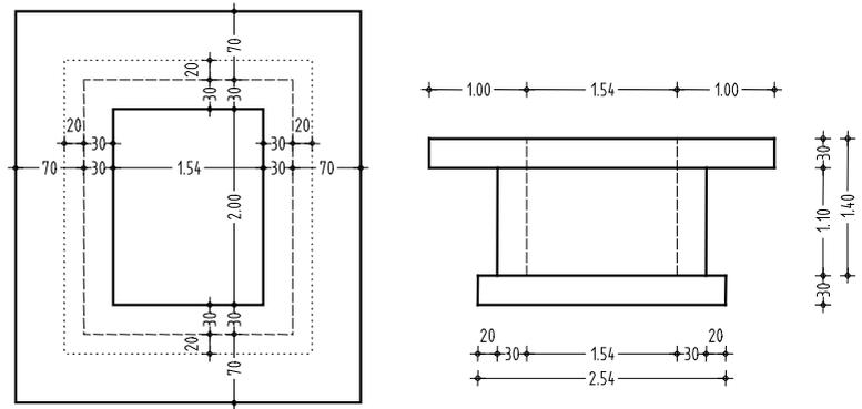
Sie zeichnen eine Aufzugsunterfahrt für das Kellergeschoss der Übung 1 mit Funktionen des Aufgabenbereichs **3D-Objekte** bzw. alternativ mit Funktionen des Aufgabenbereichs **Bauteile**.
