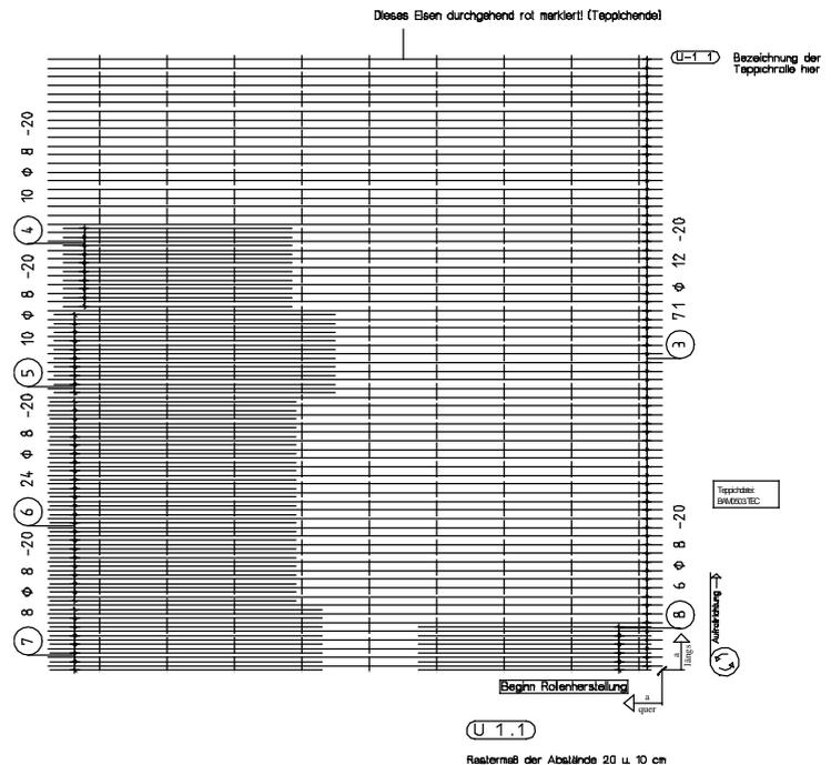
Bewehren Sie nun analog zum Teppich U1.1 selbständig das Teppichpolygon U1.4. Der Beginn der Rollenherstellung (=Startpunkt der Verlegung) bei Teppich U1.4 ist in der linken unteren Ecke des Teppichpolygons. Die Abstände der einzelnen Zulagen haben folgende Werte (Bezugspunkt oben bzw. unten rechts):
