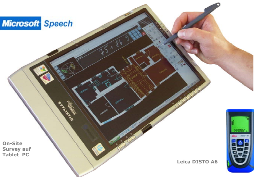
Abbildung: Erfassung von Grundrissen mit On-Site Survey
