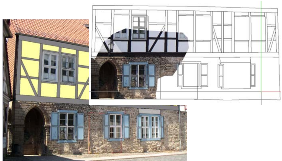
Abbildung: Komfortable Aufnahme einer Fassade mit On-Site Photo und Allplan
