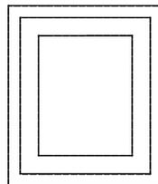
Grundriss Schachtwände d=30cm
